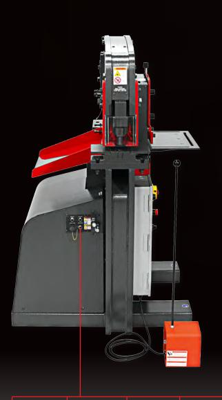
THE EXCLUSIVE EDWARDS POWERLINK™ SYSTEM TURNS YOUR 65 TON IRONWORKER INTO A POWER SOURCE FOR OUR EVER INCREASING LINE OF **HYDRAULIC TOOLS.**
